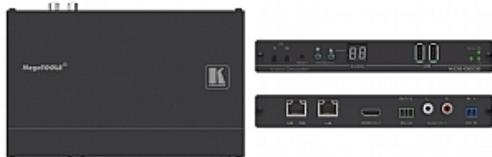
Der KDS-DEC6 Dekodierer bietet Streaming über ein IP-Netzwerk für 4K @60 Hz (4:2:0) Video, Audio, IR, RS-232, USB über IP mit HDCP 2.2 in Unicast- (eins auf eins) oder Multicast- (viele auf viele) Konfigurationen
