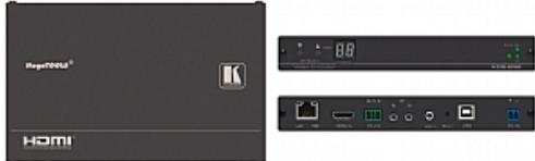
Der KDS-EN6 Kodierer bietet Streaming über ein IP-Netzwerk für 4K @60 Hz (4:2:0) Video, Audio, IR, RS-232, USB über IP mit HDCP 2.2 in Unicast- (eins auf eins) oder Multicast- (viele auf viele) Konfigurationen
